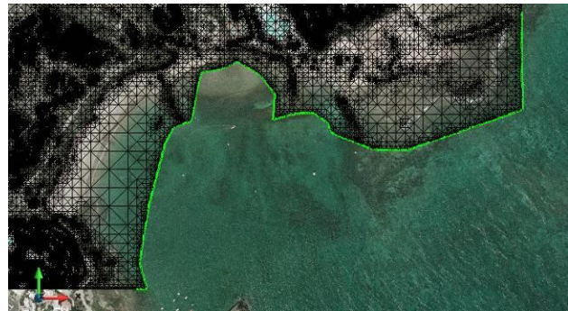
Figura 35. Ej. de condición de salida (calado=0m)
